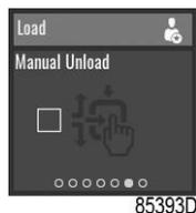
手动卸载只能在机器处于加载和本地控制状态时激活。
