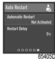
控制器具有一个内置功能，可以在断电之后恢复电压时自动重启压缩机。此功能在压缩机组出厂时已停用，只有在输入密码后才能修改，请咨询您的供应商以激活此功能。
